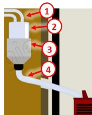
Dans ce cas de l'utilisation d'un doseur « Fire Tank », le montage est similaire, hormis le fait que l'entonnoir est intégré de base dans le produit. Il dispose également d'autres avantages, esthétique et d'installation comme la possibilité d'intégration en encastré.
